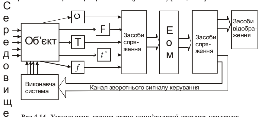
Рис.4.14. Узагальнена типова схема комп'ютерної системи контролю, ідентифікації та вимірювання реологічних характеристик речовини
